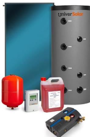
O circuito consta também de um vaso de expansão, o qual se encarga de absorver as dilatações que sofre o fluido portador de calor devido às alterações de temperatura dentro do circuito evitando a evaporação do mesmos, bem como evita que as tubagens e restantes componentes sofram danos. O fluido portador de calor utilizado é uma mistura de água e anticongelante (propileno-glicol) para reduzir a corrosão e evitar o congelamento do fluido a baixas temperaturas ambientais.
